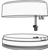
Entfernen Sie den Deckel des Ei Electronics Melders. Der Mobeye CM4410 wird als Deckel verwendet werden. Drücken Sie den verkabelten grünen Stecker in die Pins (bezeichnet mit Text 1 2) des Ei Electronics-Detektors. Stellen Sie sicher, dass der (in der Regel) graue Stecker des Ei Electronics-Detektors entfernt ist.
