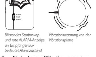
Blitzendes Stroboskop und rote ALARM-Anzeige an Empfänger-Box bedeutet Alarmzustand
